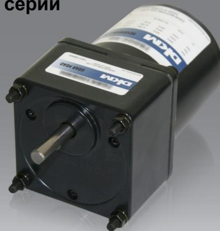
В мотор-редукторы встроены термopредохранители, обеспечивающие защиту от перегрева. При нагреве двигателя до 120°C происходит автоматическое отключение питания. При снижении температуры до 90 °C питание восстанавливается.
