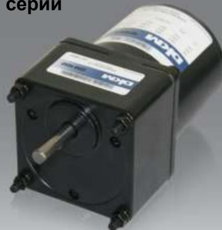
В мотор-редукторы встроены термозащиты, обеспечивающие защиту от перегрева. При нагреве двигателя до 120°C происходит автоматическое отключение питания. При снижении температуры до 90 °C питание восстанавливается.
