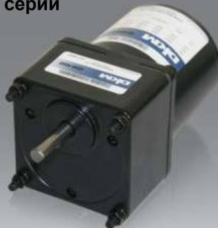
Для предотвращения перегрева мотор-редукторы имеют дополнительную защиту в виде встроенных термopредохранителей. При нагреве двигателя до 120°C происходит автоматическое отключение питания. При снижении температуры до 90 °C питание восстанавливается.
