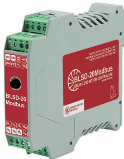
Контроллеры BLSD-20Modbus предназначены для управления трехфазными бесколлекторными двигателями постоянного тока с датчиками Холла с номинальным током до 20А. Контроллеры регулируют скорость вращения двигателя, задают направление вращения, управляют разгоном и торможением двигателя, обеспечивают позиционирование по информации от датчиков Холла и имеют функцию удержания положения. Благодаря функции ограничения тока контроллеры защищают двигатель от перегрузок.
