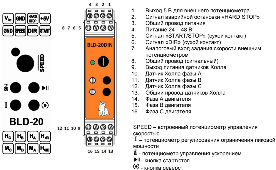
Рис. 2. Схема расположения и назначение клемм и элементов управления.
