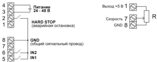
Рис. 3. Подключение питания и внешних цепей управления
